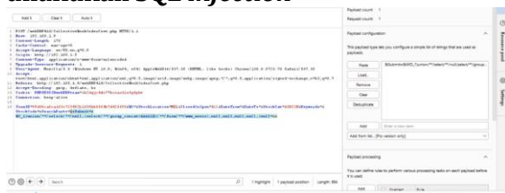
Gambar 10. Send to Intruder untuk memunculkan halaman yang siap dilakukan SQL injection
